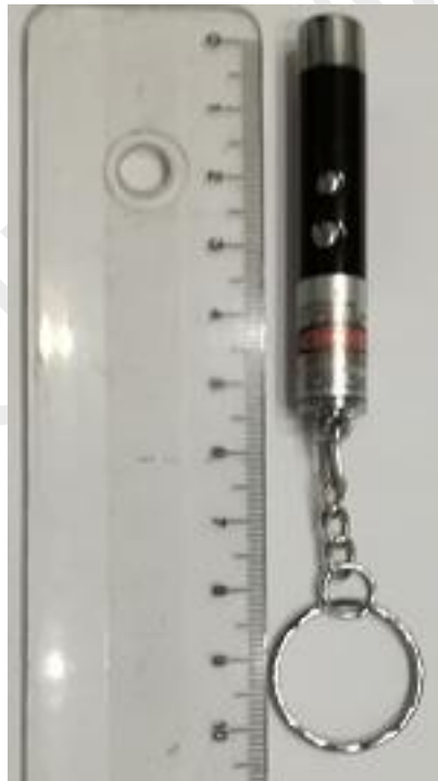
Fotografía 1 del puntero láser, cuya longitud es de unos seis centímetros. El botón brillante delantero apaga y enciende el láser. El otro botón apaga y enciende una pequeña luz normal
