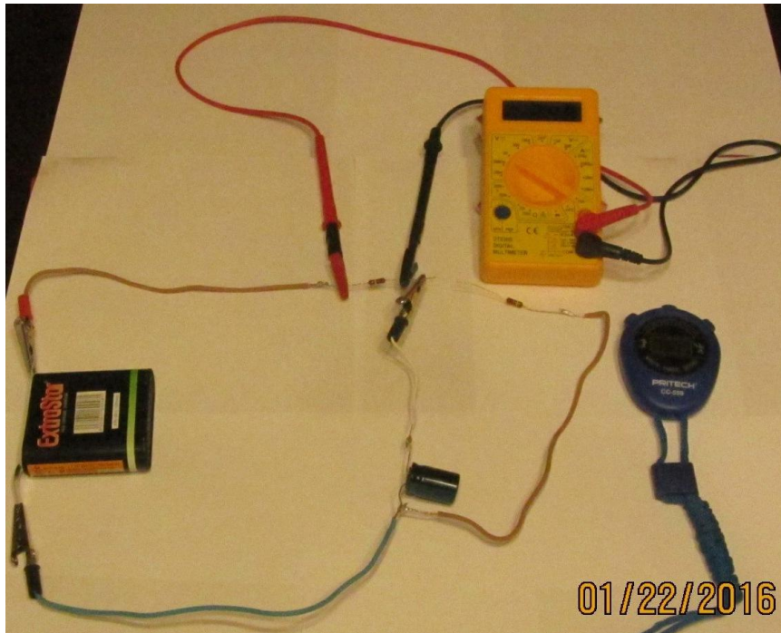
Fotografía 1.- Esta fotografía se corresponde con el circuito de la izquierda de la figura 1. El condensador se está cargando y el voltímetro mide la caída de tensión entre los bornes de la resistencia de 220\text{ k}\Omega . El cronómetro mide el tiempo. El circuito de la derecha está desconectado.
