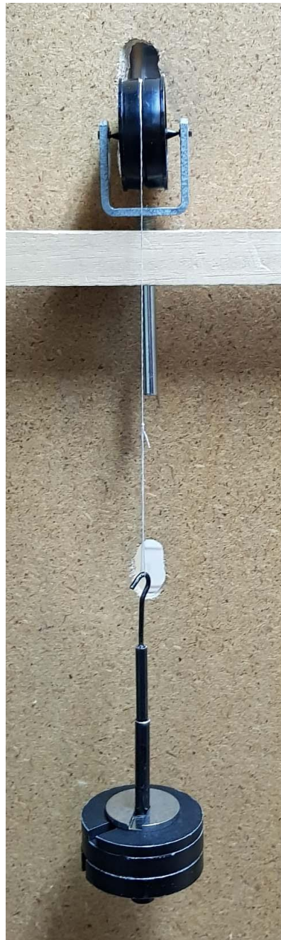
Fotografía 2. Es la parte del sistema donde está colocada la polea con el portapesas y las pesas. El peso de estos es la tensión experimental T que actúa sobre la cuerda. Se desprecia cualquier rozamiento en la polea.
