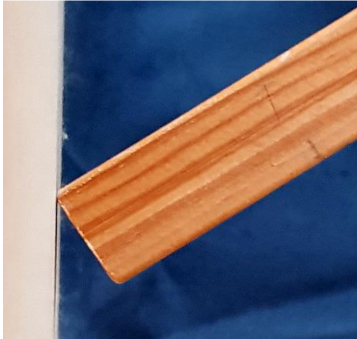
Fotografía 4.- El listón tiene una sección normal que es un rectángulo .En la fotografía se observa que el apoyo sobre el tablero es sobre una arista y esta es probablemente la razón de que sea tan costoso lograr los equilibrios.
