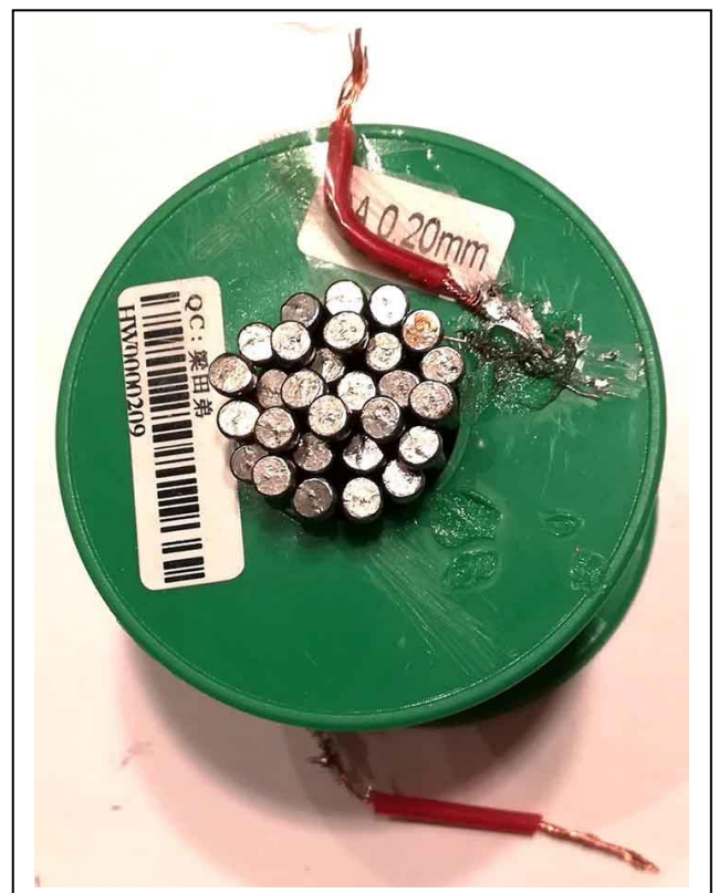
Fotografía1.- Bobina utilizada en esta práctica y en la anterior denominada circuito RL. Allí se midió la resistencia óhmica obteniéndose como valor 57,5 \Omega .
