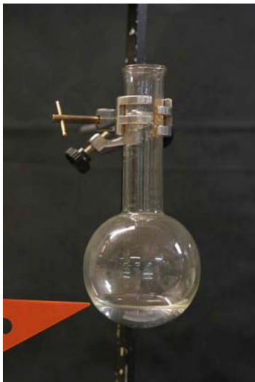
Fotografía 2.- Vista ampliada del matraz de fondo redondo con agua. La forma del agua en el recipiente constituye una lente convergente plano convexa. La lectura del índice de color rojo sobre la regla nos mide P_2 ,
