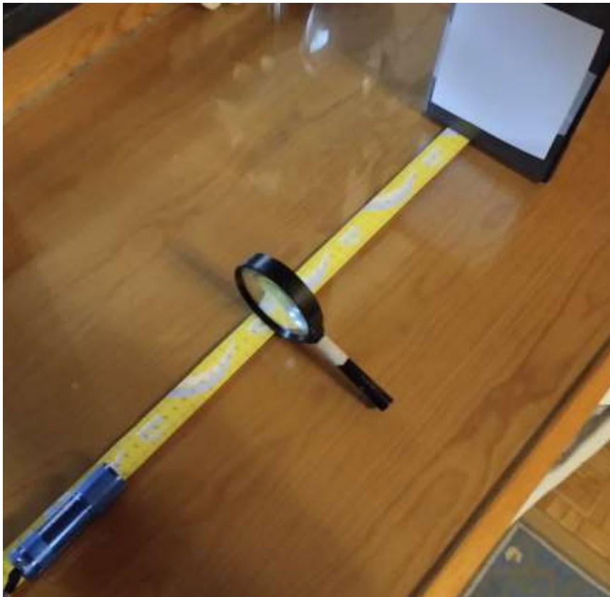
Fotografía 1.- Este es el dispositivo. De izquierda a derecha linterna, lente y pantalla. Los tres objetos están sobre el metro. La graduación del metro permite determinar en cada medida las posiciones de la lente, el objeto (los leds de la linterna) y la pantalla
